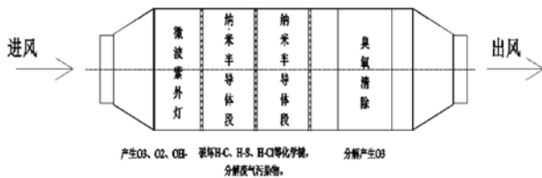
图4 光氧离子废气处理机处理过程
